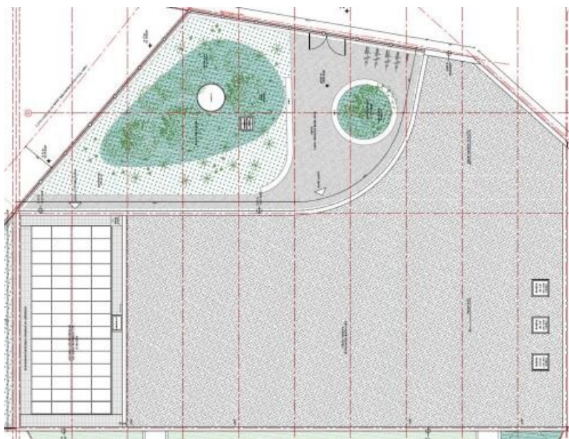
Toiture principale du bâtiment considéré. Positions des panneaux solaires photovoltaïques.
